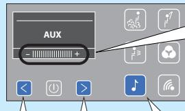
Sul display viene visualizzato l'indicatore di livello del volume.
